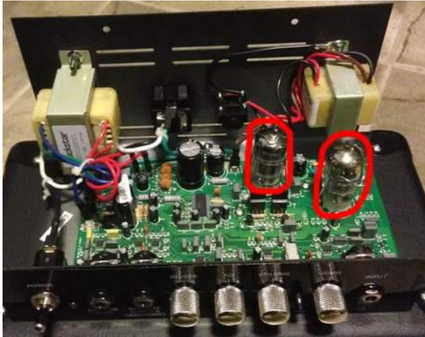
FIGURE 5 – Circuit interne du Blackstar HT-1. Les deux lampes sont entourées en rouge.
